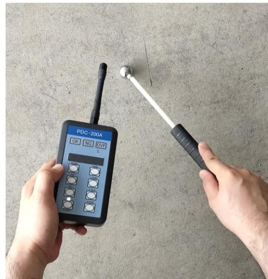
写真-3 打音取得機器 (PDC-200A)
